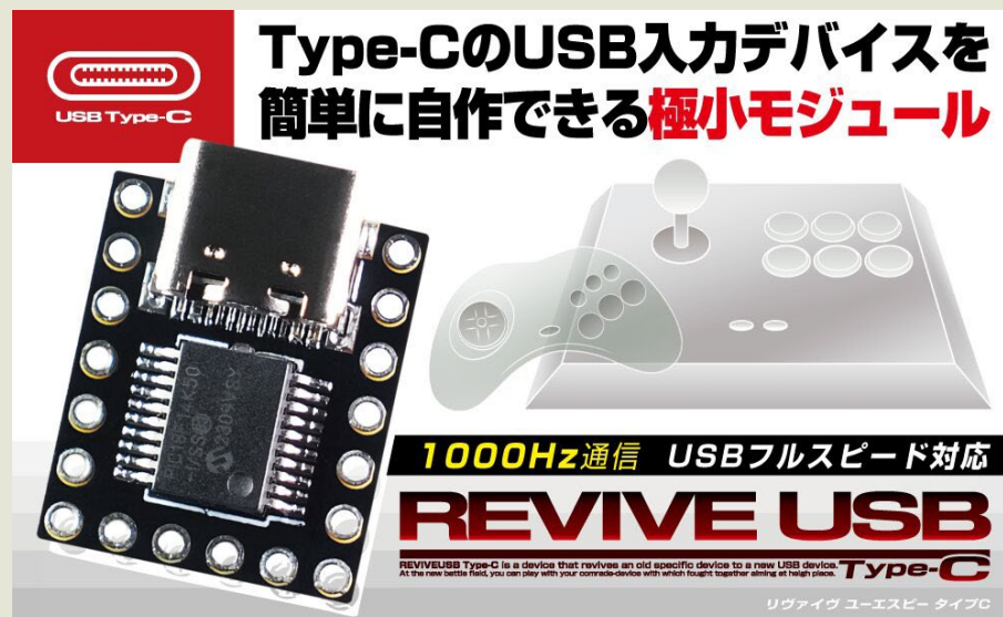
図 8-10 スイッチを接続するだけでコントローラーを簡単に制作できる
